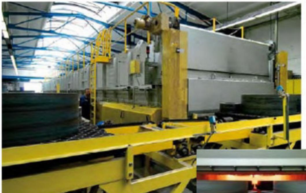
Ein imposantes Stück – der neue Glühofen in der Produktlinie Schmiede des Werks Schweinfurt ist insgesamt 50 Meter lang und gute 120 Tonnen schwer.
